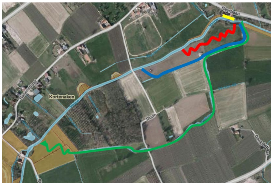
Ontwerpscenario's voor optimalisatie vistrappen t.h.v. de Arnautsmolen (groen: langs Gelbeek, blauw: langs Gelbeek en waterloop, rood: nieuwe bypass; geel: optimalisatie bestaande vistrappen)
