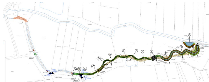
Ontwerpplannen (in opbouw) voor aanleg van een meanderende bypass om het val thv de molen vispasseerbaar te maken.
