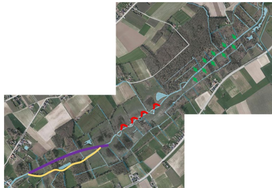
Figuur: Velpe tussen Nieuwstraat en uitlaat van het gecontroleerd overstromingsgebied (paars: afschuinen oevers, oranje: watervoerend maken van oude Velpe; rood: nieuwe meanders, groen: natuurlijke stroomdeflectoren)
