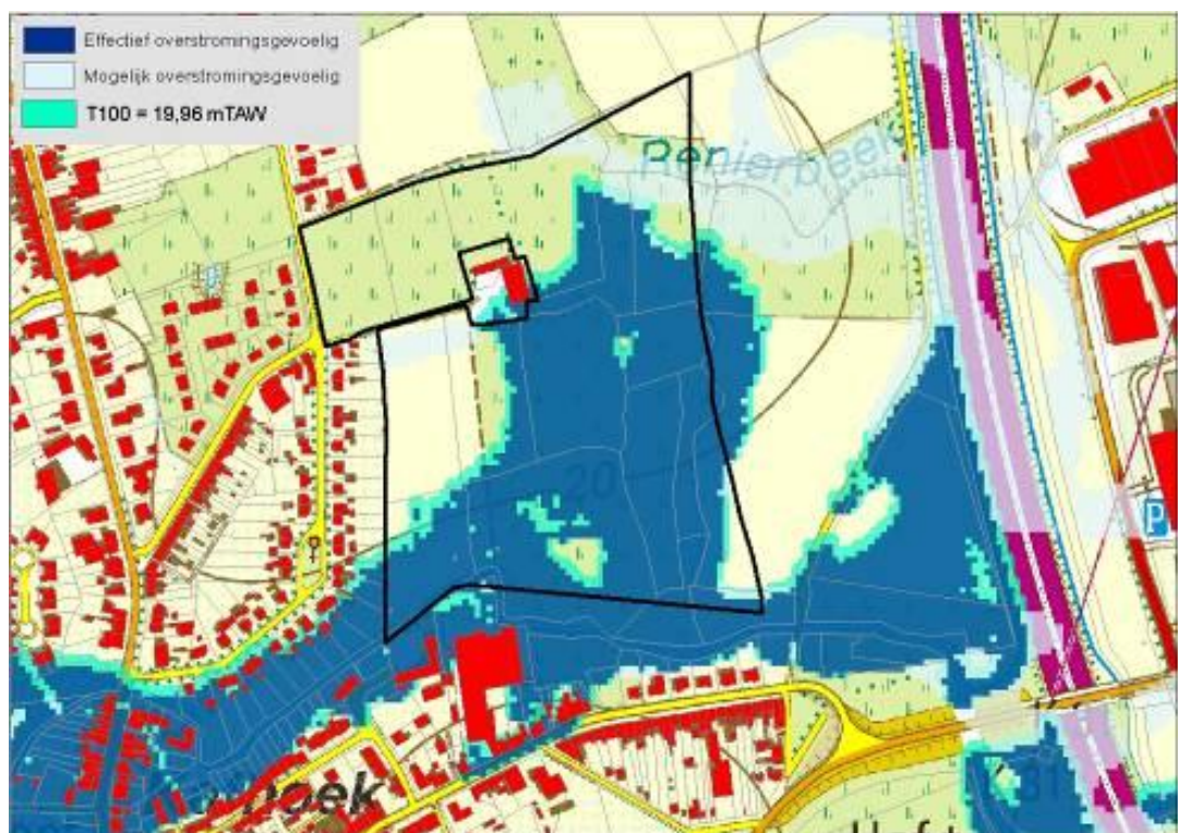
Figuur 4: overstromingscontour voor een retourperiode van 100 jaar thv het aandachtsgebied + de watertoetskaart (VMM, waterkwantiteitsmodellering, nov. 2011)
