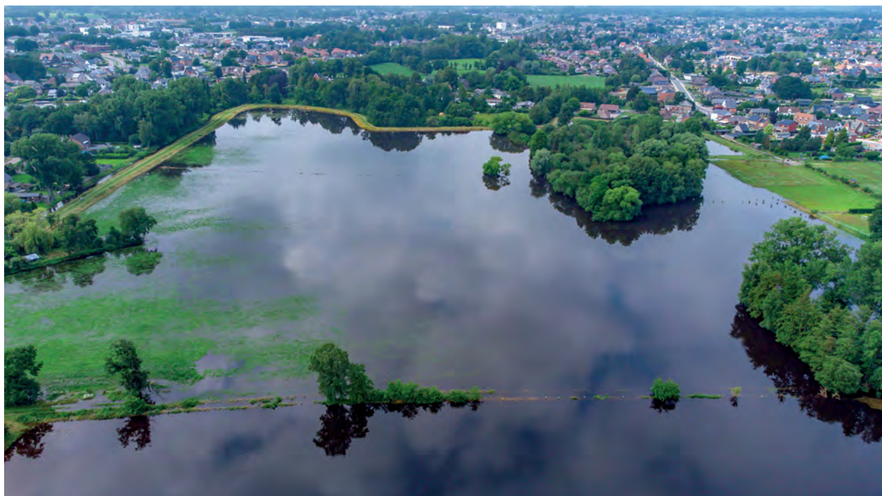
Het wachtbekken in Pelt buffert meer dan 200 miljoen liter water na hevige regenval in juli 2021 (Foto: Marc Faes).
