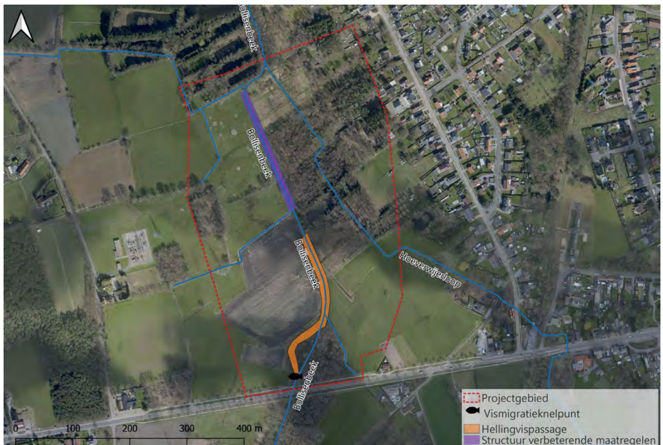
Voorkeursscenario om het vismigratieknelpunt op de Bolissenbeek thv de Peerderbaan op te lossen.
