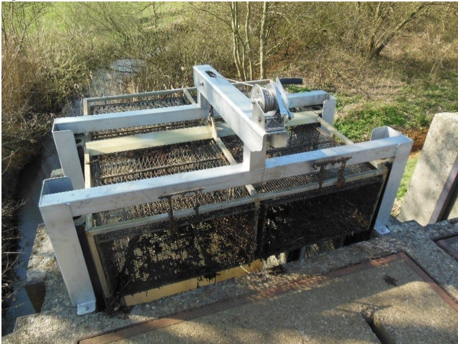
Figuur 18: Kooi met fuiken, het mechanisch katrolsysteem staat bovenaan. let op het bladafval in/op de fuiken
