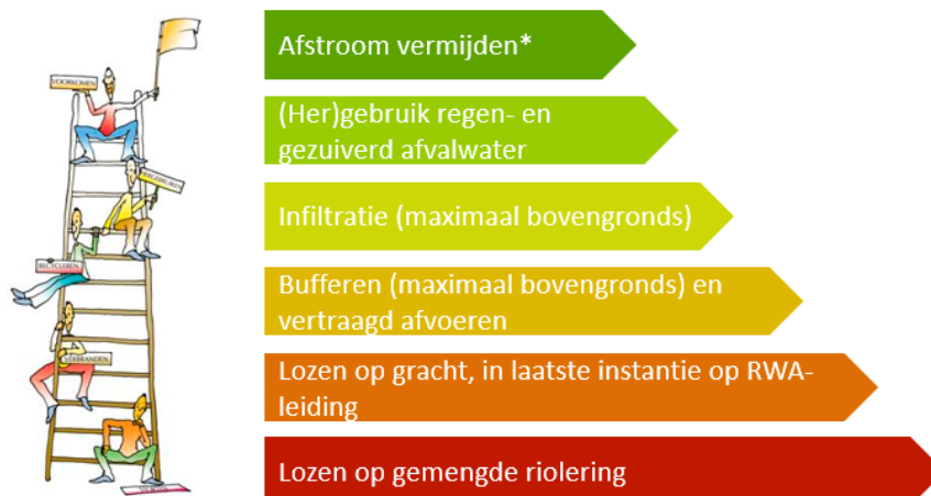
Figuur: Ladder van Lansink (*Afstroom vermijden kan door verharding te beperken, drainage te verminderen, ...)
