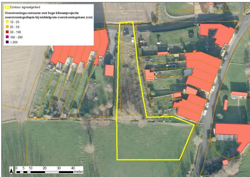
Figuur: De overstromingsdieptes van de middelmatige overstromingscontour met extreme klimaatsverandering worden hier weergegeven (geel= lage overstromingsdiepte tot paars= hoge overstromingsdiepte).
