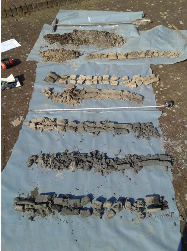
Foto 1: opgeboorde boorgrond van boring B2 van 0 (boven) tot 8 m (onder)
