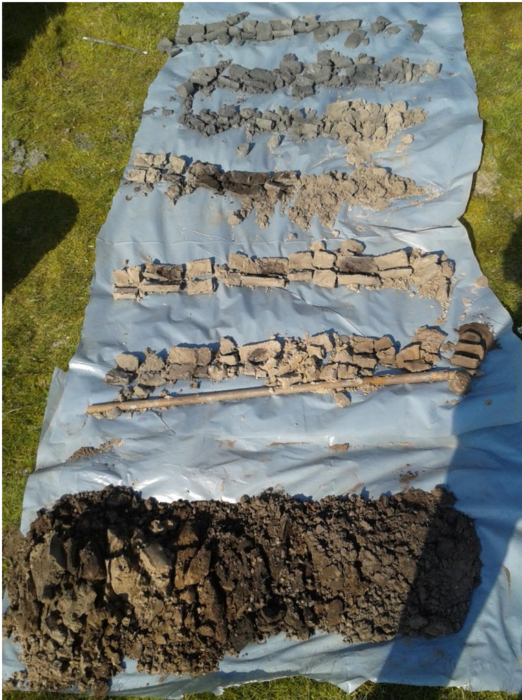
Foto 5 : opgeboorde grond van boring B4 van onder (0 m) naar boven (8 m)
