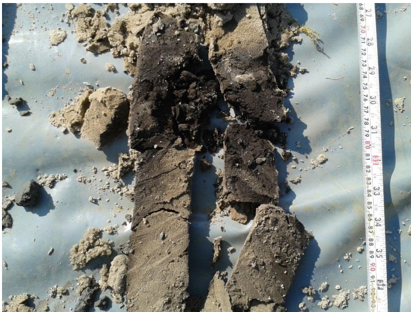
Foto 2: boring B2: detail kleilens met veen
