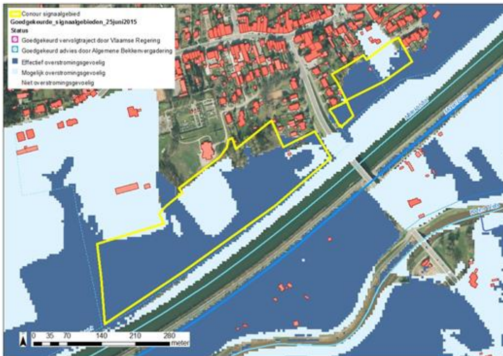
Figuur: watertoetskaart van het signaalgebied op recente orthofoto (medio 2015) met aanduiding van de overstromingsgevoelige gebieden (lichtblauw = mogelijk overstromingsgevoelig; donkerblauw = effectief overstromingsgevoelig), volgens Ministerieel Besluit dd. 1/6/2014.
