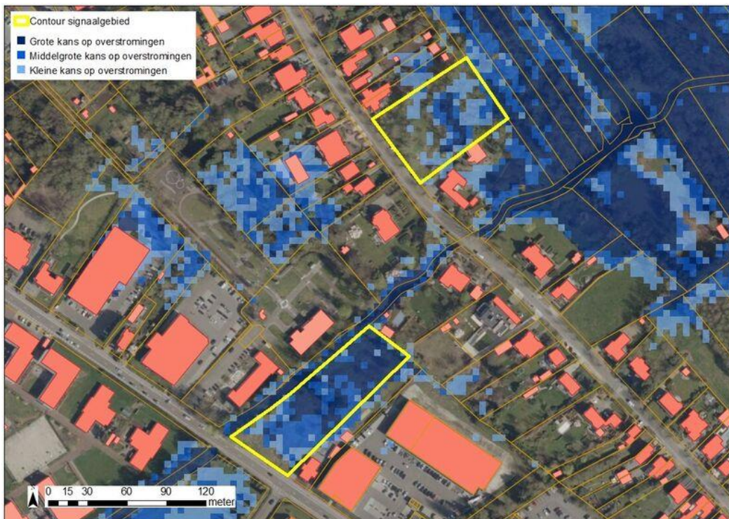
Figuur: De blauwe contouren geven overstromingskansen met klimaatsverandering weer. Hoe donkerder blauw, hoe groter de overstromingskansen. De groene contour geeft de recente overstroomde gebieden (ROG) weer, waar geen specifieke overstromingskansen gekend is.
