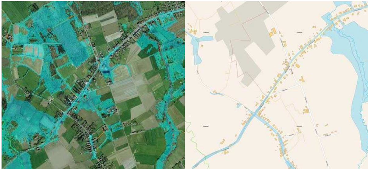
Figuur 216 Gesimuleerde en waargenomen overstromingen op de Maldersesteenweg in Lippelo en 't Zwaantje in Malderen vanuit de Grote en Kleine Molenbeken
