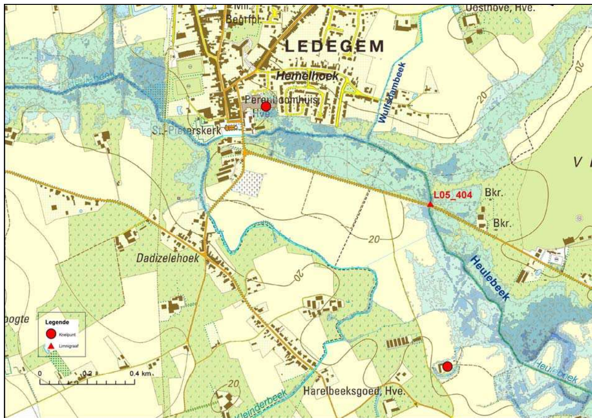
Figuur 292 Gesimuleerde overstromingscontouren van de Heulebeek in Ledegem tijdens de november 2010 storm
