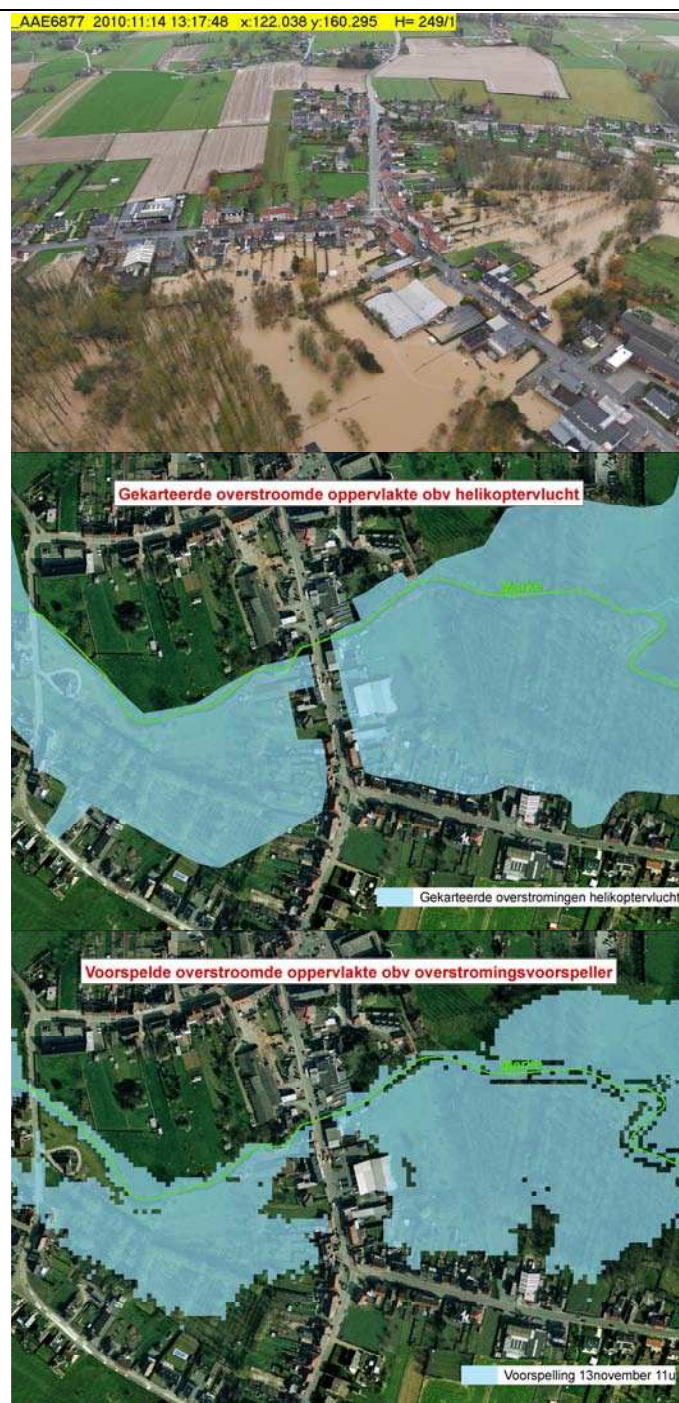
Figuur 102 Nieuwstraat in Galmaarden. boven: foto genomen tijdens helikoptervlucht, midden: gekarteerde overstromingen obv helikoptervlucht, onder: gesimuleerde, voorspelde, maximale overstromingen (simulatieresultaten van 13 november 11u)
