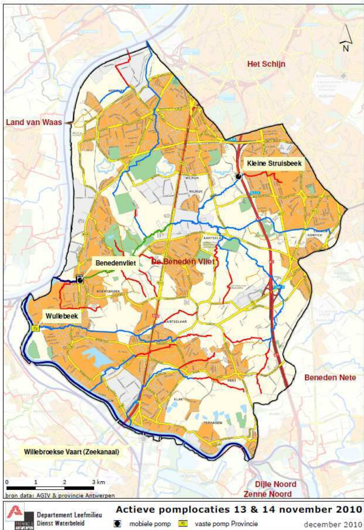
Figuur 19: Overzicht van de actieve pomplocaties in het waterschap De Beneden Vliet op 13 en 14 november 2010.
