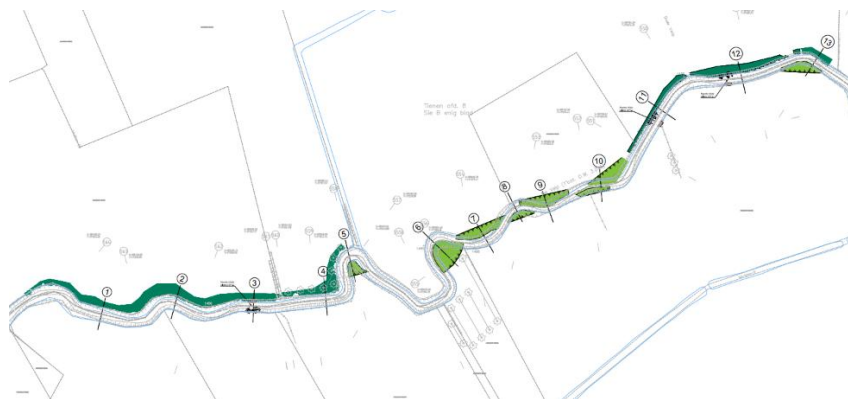
Figuur: Afgraven van kunstmatige ruimingswallen ifv hydromorfologische opwaardering.
