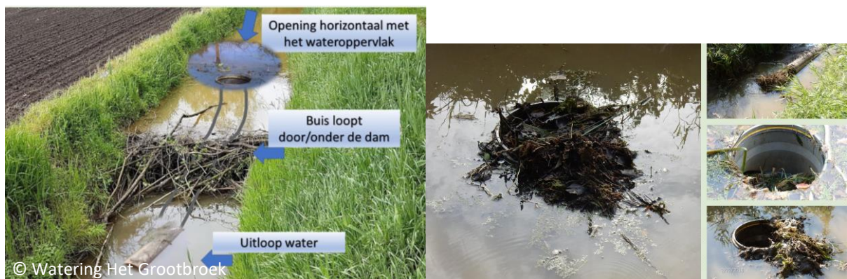
Figuur 12: (Links) opstelling 1 waarbij de opening van de buis horizontaal is t.o.v. het wateroppervlak, (Rechts) de reactie van de bever
