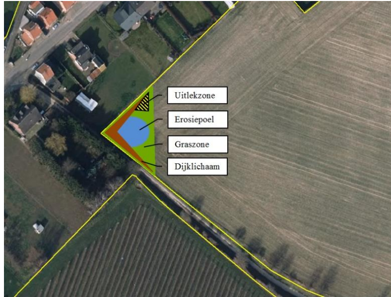
Figuur 24: Optimalisatie bestaande damconstructie aan de Millerweg in Sluizen (Tongeren)
